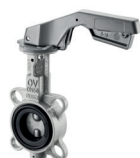
Межфланцевый дисковый поворотный затвор, PN 16 с гладкими проушинами, с позиционируемым рычагом
