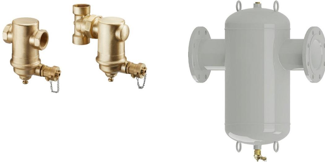
Сепараторы шлама непрерывно удаляют мельчайшие частицы грязи без значительного увеличения сопротивления потоку. Сильный магнит удерживает магнетиты. Когда магнит извлекается, магнитные частицы попадают в поддон и промываются через шаровой кран без прерывания работы системы.
